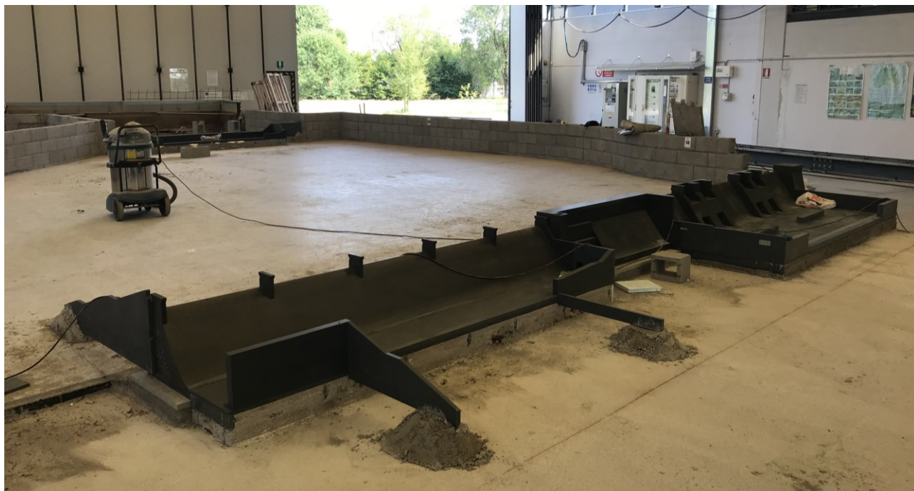
Figura 2-10 - Manufatto B e manufatto A con relative vasche di dissipazione assemblate.
