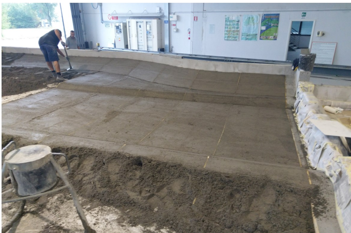
Figura 2-17 - Riempimento con magrone nel tratto di alveo a monte del manufatto regolatore.
