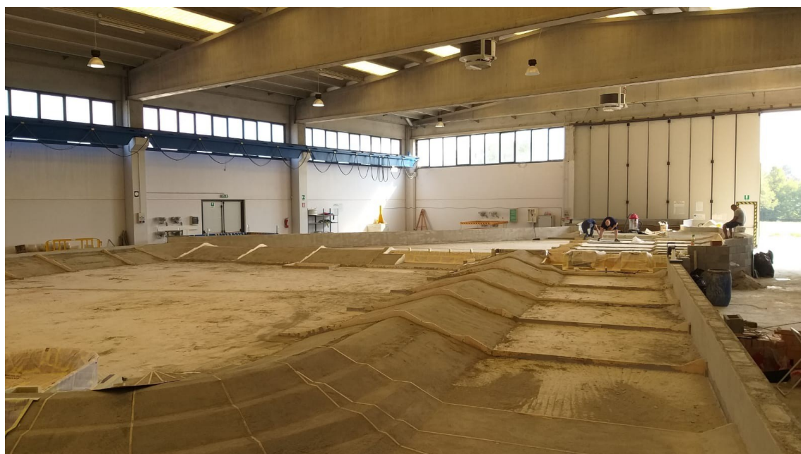
Figura 2-15 - Sagomatura dell'alveo e degli argini.
