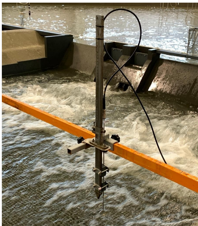
Figura 2-25 – Assemblaggio del micromulinello per la misura della velocità della corrente idrica nel modello. È visibile il supporto scorrevole sul traverso arancione.
