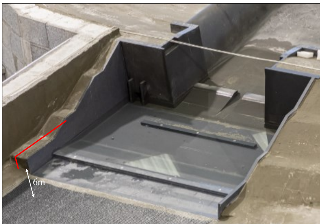
Figura 3-21 - Particolare del contenimento laterale in sponda destra del manufatto C, con indicazione della nuova quota del coronamento del muro.
