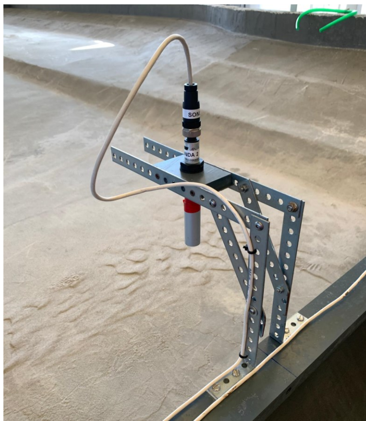
Figura 2-22 - Misuratore di livello a ultrasuoni in esercizio.
