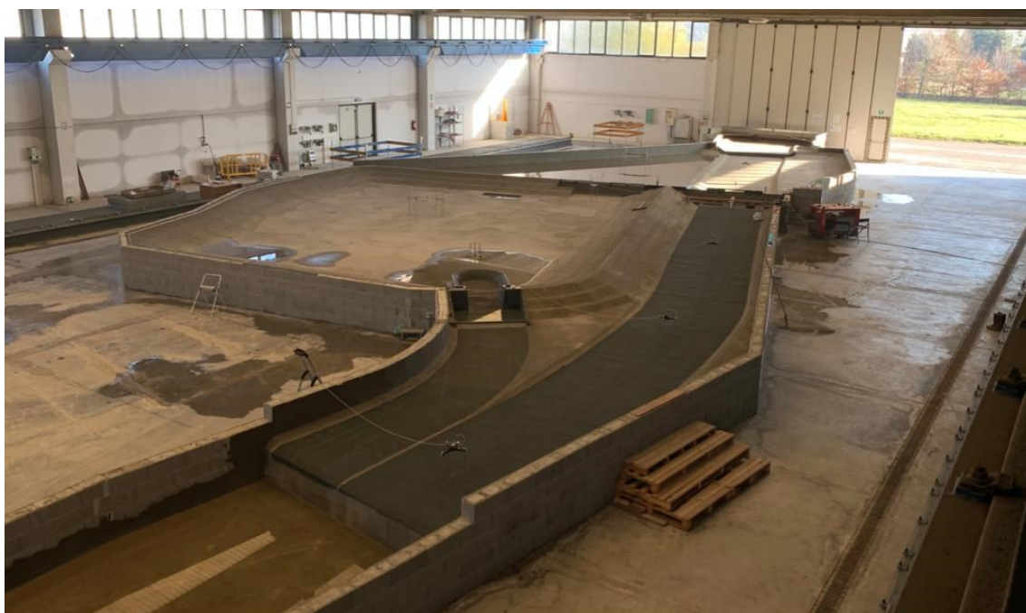
Figura 2-20 – Vista dell'intero modello dopo la posa della rete metallica.
