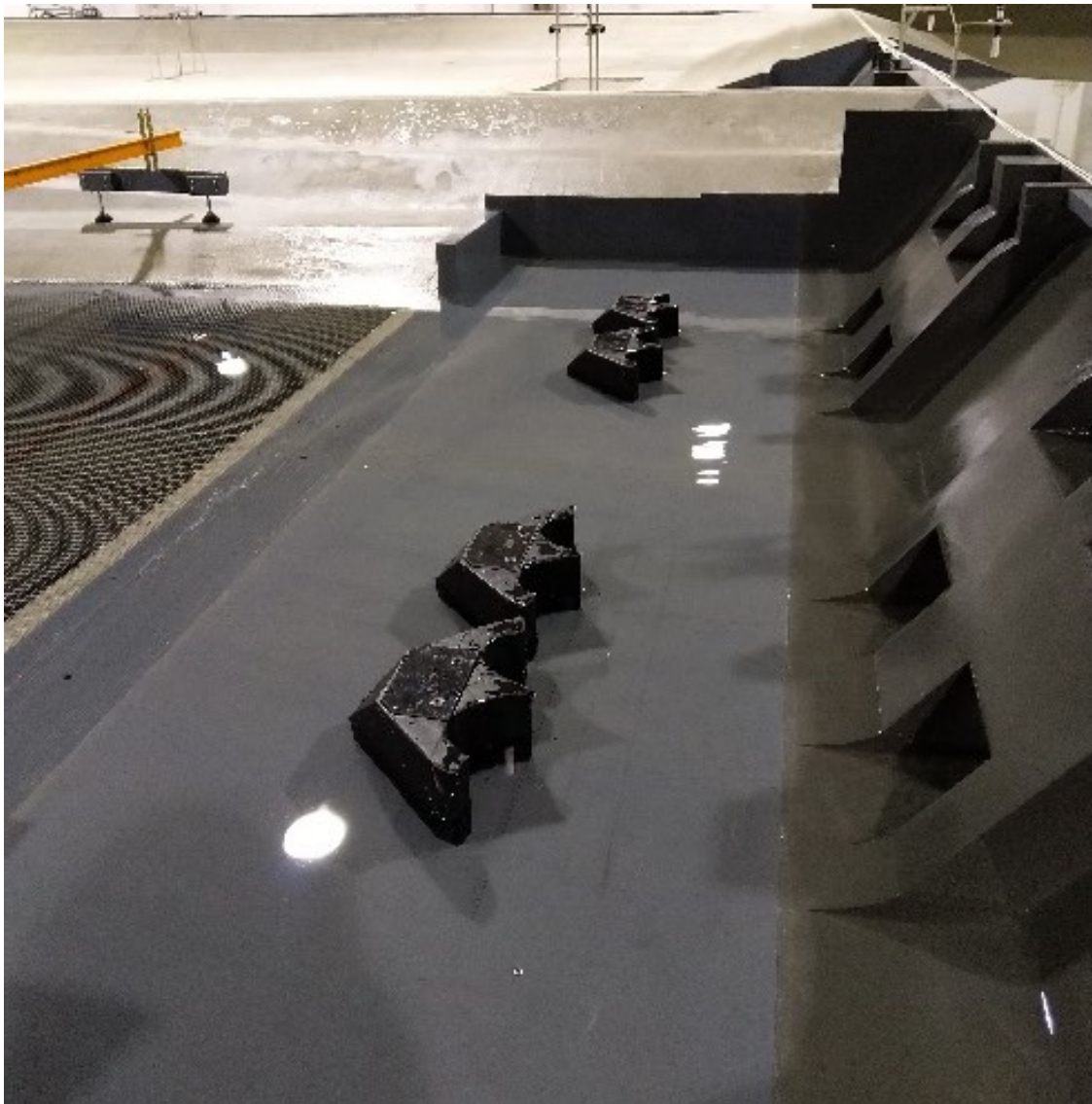
Figura 3-4 - Manufatto A con blocchi di dissipazione a doppio cucchiaino.
