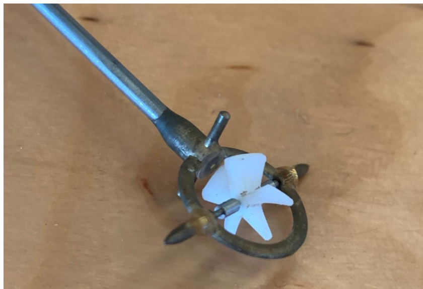
Figura 2-24 - Micromulinello idrometrico Nixon 403 utilizzato in laboratorio per le misure puntuali di velocità.
