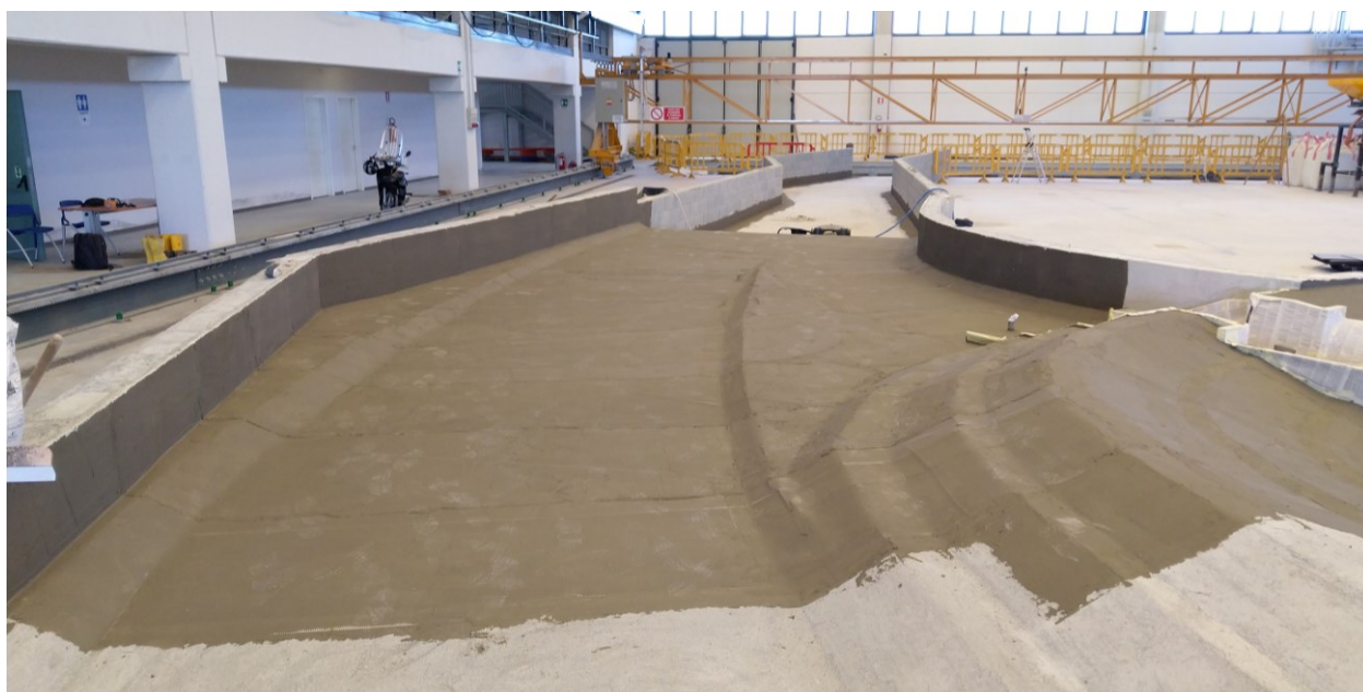
Figura 2-18 - Fase di impermeabilizzazione del modello fisico.
