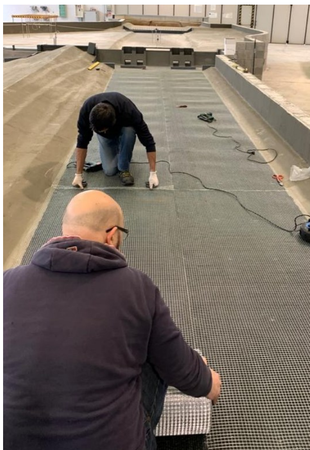
Figura 2-19 - Posa in opera della rete per rendere il fondo dell'alveo del modello più scabro.
